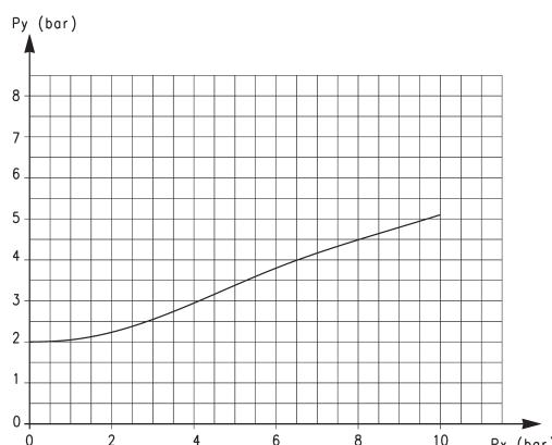
El diagrama muestra la relación entre la presión de trabajo ( Px ) y la presión necesaria para accionar la válvula ( Py ). La presión de trabajo de la válvula de bloqueo unidireccional es 0,3 bar.
