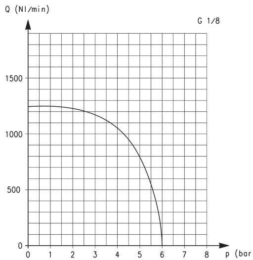
Diagrama de caudal para los modelos VBU y VBO, CONEXIONES G1/8.
