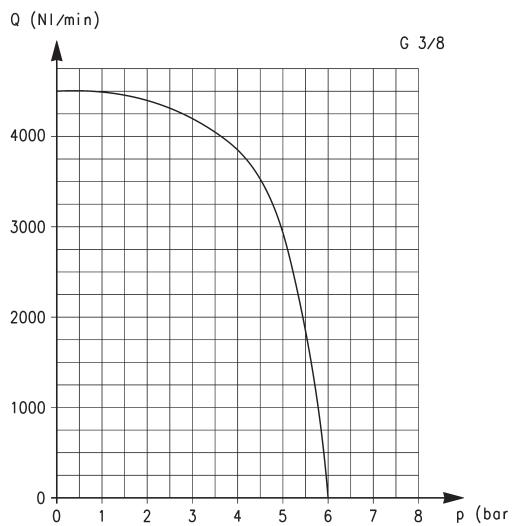
Diagrama de caudal para los modelos VBU y VBO, CONEXIONES G3/8.
