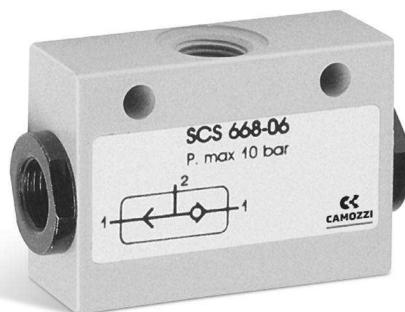
El selector de circuito Mod. SCS-668-06 permite canalizar dos señales que proveniendo alternativamente de dos puntos distintos terminan en el mismo punto.
